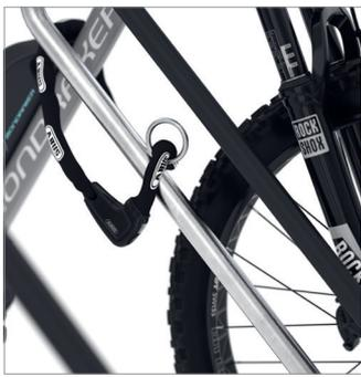
Ceillots de fixation intégrés pour optimiser la mise en place de dispositifs antivol.
