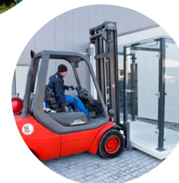
Ist in Zukunft eine Umplatzierung der Kabine gedacht, ist auch das schnell und einfach vollzogen. Mit einem Gabelstapler kann die Kabine nach Belieben bewegt werden.
